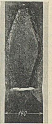
Abb. 12. Bruchbild einer schwelend beanspruchten Laschenverbindung. (Versuche von Prof. Graf, Stahlbau 1933, Heft 12/13.)
