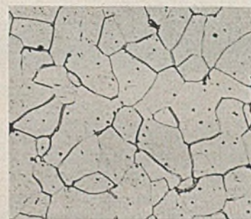
Bild 3b. Gefüge im Flansch des Trägers II.
