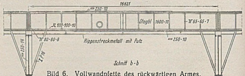
Bild 6. Vollwandpfette des rückwärtigen Armes.
