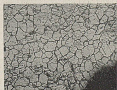
Bild 14. Gefüge nach dem Glühen bei 810°.
