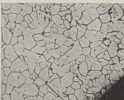
Bild 12. Nach dem Glühen bei 910°.
