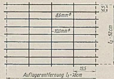
Bild 14. Modellrost A<sub>2m</sub> mit den Meßstellen 1 bis 9 am mittleren Querstab.
