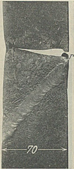
Abb. 24. Gasschmelzschweißung nach Abb. 17 b; Wurzel nachgeschweißt. Bruch nach 844 800 Lastwechseln im angeschlossenen Stab ungünstiger wird; die Kraftlinien müssen bei kürzeren Nähten mit schärferer Ablenkung und gedrängter nach den Seiten geführt werden, wie die Beispiele in Abb. 26 u. 27 erkennen lassen. Der Einfluß der Länge der Schweißnaht war deshalb weiter zu untersuchen, auch weil die Nahtlänge in Stücken, die oftmals wiederholte Lasten aufnehmen sollen, nach DIN 4100 länger sein soll als bei unseren bisherigen Versuchen. Der Einfluß der Nahtlänge ist natürlich begrenzt; nach unseren bis Ende 1932 vorliegenden Feststellungen ist bei sachgemäßer Stärke der Naht eine Verlängerung über die übliche normengemäße Länge hinaus ( \rho : \sigma = 0,5 : 1 ) bei Zugverbindungen von untergeordneter Bedeutung. Z. B. fand sich für Stücke nach Abb. 13 bei l = 60 \text{ mm} ( \rho : \sigma = 0,5 : 1 ) bei l = 120 \text{ mm} ( \rho : \sigma = 0,25 : 1 ) mit Gasschmelzschweißung D_{zu} = 9 10 \text{kg/mm}^2 , mit Lichtbogenschweißung D_{zu} = 6 7 \text{kg/mm}^2 23). Weitere Versuche sind vorgesehen.
