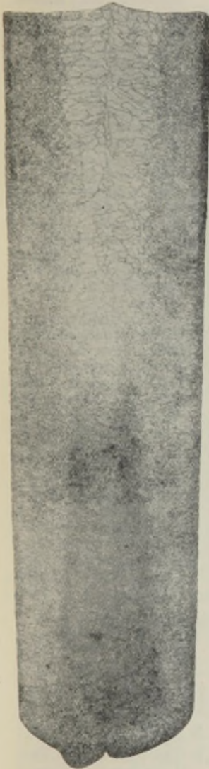
Abbildung 1. Nickelstahl, heiß vergossen.
