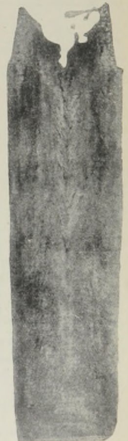
Abbildung 4. Automatenstahl, unruhig vergossen.
