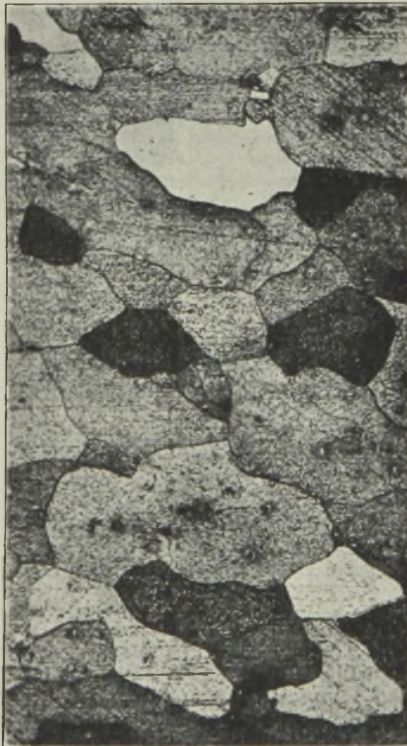
Abbildung 5. Gefüge einer Legierung mit 4% Si, geschmiedet und geglüht.
