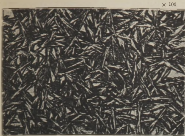
Abbildung 9. Gefüge einer Legierung mit 7,1% Si, von 1050° in Wasser abgeschreckt.
