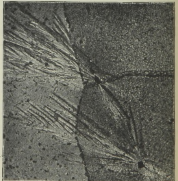
Abbildung 8. Gefüge einer Legierung mit 6,26% Si, bei 1100° in Wasser abgeschreckt.
