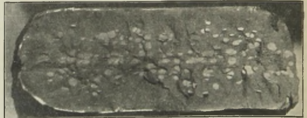
Abbildung 2. Starke Flockenbildung in einem Chrom-Wolfram-Stahl.
