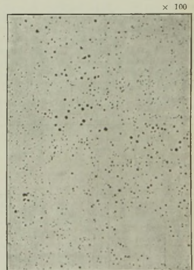
Abbildung 5. Eisen-Sauerstoff-Legierung mit 0,225% O, ungeätzt.
