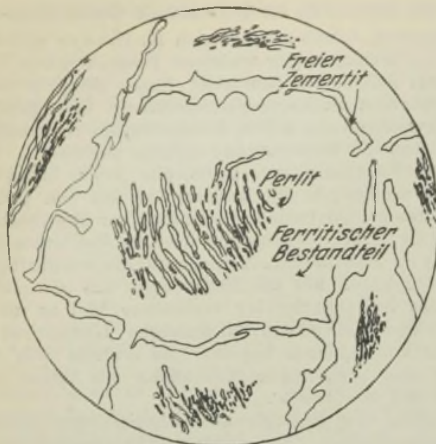
Abbildung 1. Gefüge der Oberflächenschicht einer zementierten Stahlprobe mit etwa 0,165% O.
