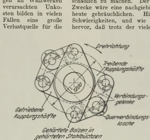
Abbildung 3. Thomas- (Thomson-) Kupplung für rd. 4500 PS und 90 U/min.
