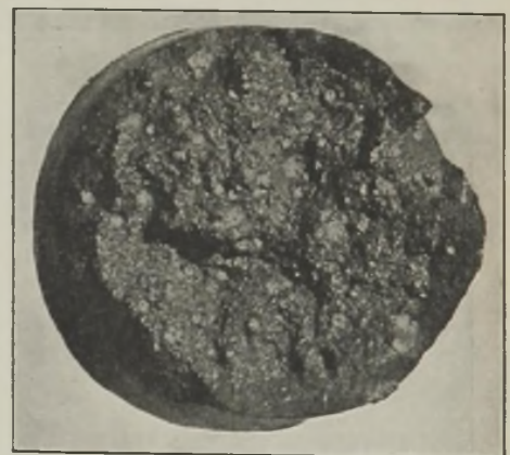
Abbildung 3. Bruchfläche der Block- schiene bei statischem Zerreiβ- versuch.
