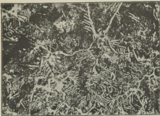
Abbildung 12. Anlieferungsgefüge zweier Stahlgußschmelzen; links nicht desoxydiert, rechts mit Vanadin desoxydiert.
