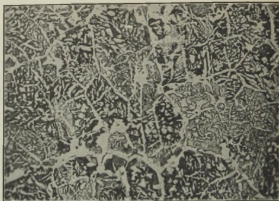
Abbildung 12. Anlieferungsgefüge zweier Stahlgußschmelzen; links nicht desoxydiert, rechts mit Vanadin desoxydiert.
