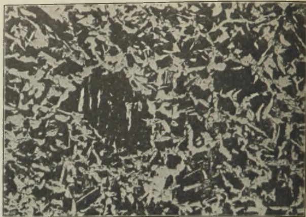
Abb. 1. Gefüge einer Blockschiene (links) und eines bei 925° geglühten, mit Aluminium desoxydierten Stahlgusses (rechts).
