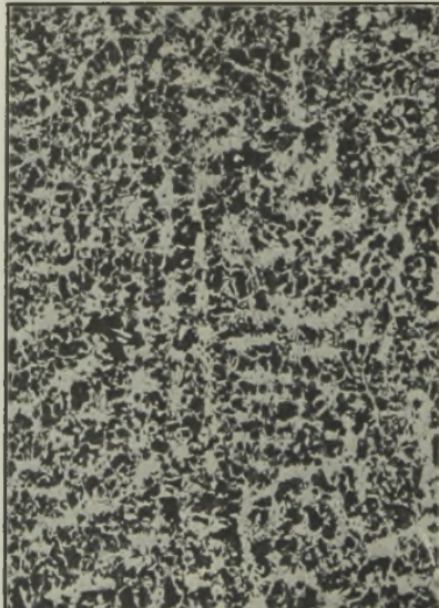
Abbildung 13. Stahlgußschmelze, manganhaltig, aber nicht desoxydiert, in feuchte Sandform gegossen.
