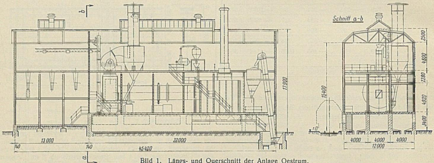
Bild 1. Längs- und Querschnitt der Anlage Oestrum.
