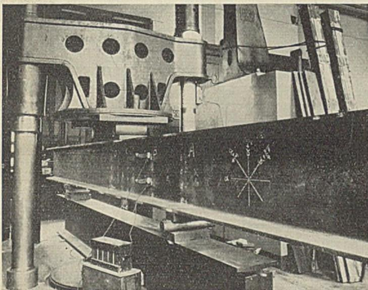
Bild 1. Der Walzträger unter der 600 t-Press.
