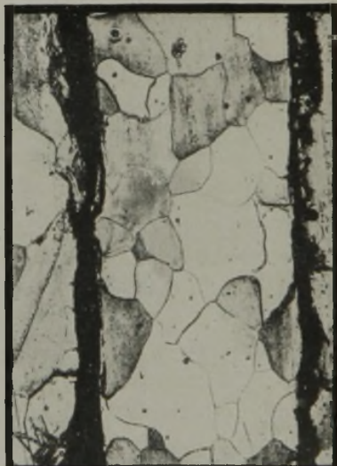
Abbildung 17. Wie Abbildung 16, gegläht. Fertigblech (Längsschliff), geätzt in Salpetersäure.
