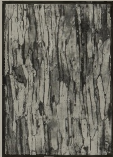
Abbildung 11. Platine nach dem 1. Gange (Längsschliff), geätzt in Salpetersäure.
