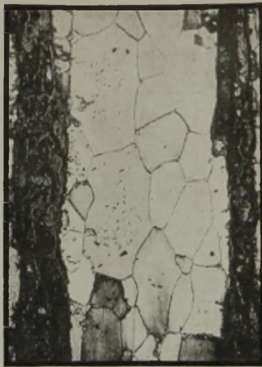
Abbildung 15. Bei 800° gewalztes Rohblech (Längsschliff), geätzt in Salpetersäure.
