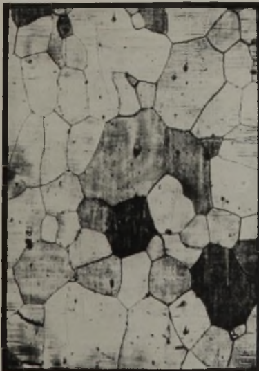
Abbildung 12. Blech nach der 1. Wärmung
