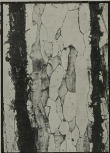
Abbildung 16. Bei 670° gewalztes Rohblech (Längsschliff), geätzt in Salpetersäure.
