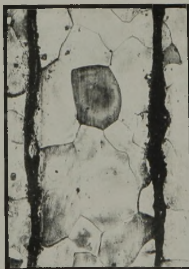
Abbildung 18. Wie Abbildung 15, gegläht. Fertigblech (Längsschliff), geätzt in Salpetersäure.
