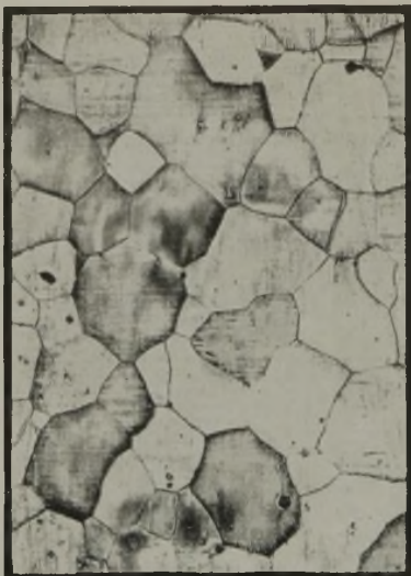
Abbildung 14. Blech nach der 2. Wärmung (Längsschliff), geätzt in Salpetersäure.
