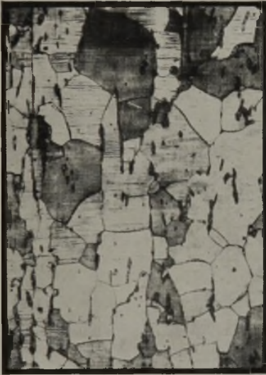
Abbildung 10. Sturz (Längsschliff), geätzt in Salpetersäure.
