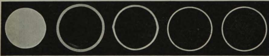
Abbildung 8. 165er Rohr; hergestellt nach dem Stiefel-Verfahren.
