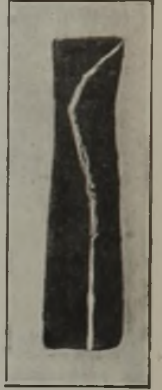
Abbildung 28. Verdrehung der Außenhaut, ermittelt durch eine eingehobelte Längsnute.
