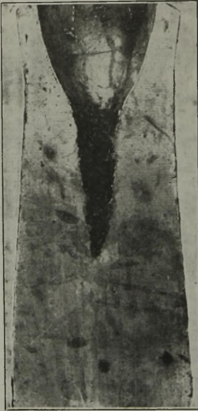
Abbildung 8. Längsschnitt durch einen abgebremsten Versuchsblock.
