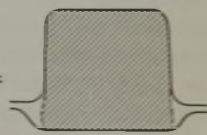
Abbildung 8. Profilform im nicht eingewölbten, wenig in die Mittelwalze eingeschnittenen Kastenkaliber.
