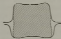
Abbildung 7. Profilform im eingewölbten, stark in die Mittelwalze eingeschnittenen Kastenkaliber.
