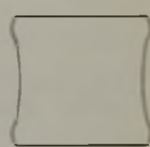
Abbildung 6. Form einer schwach gedrückten Stauchprobe.
