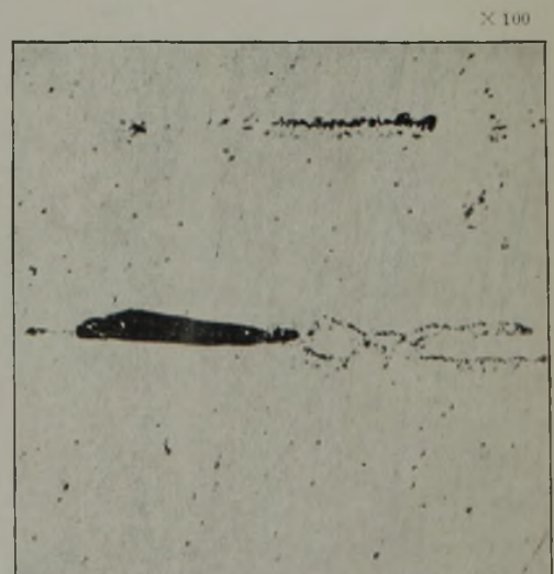
Abbildung 23. Schlackenverteilung an der Ribstelle.
