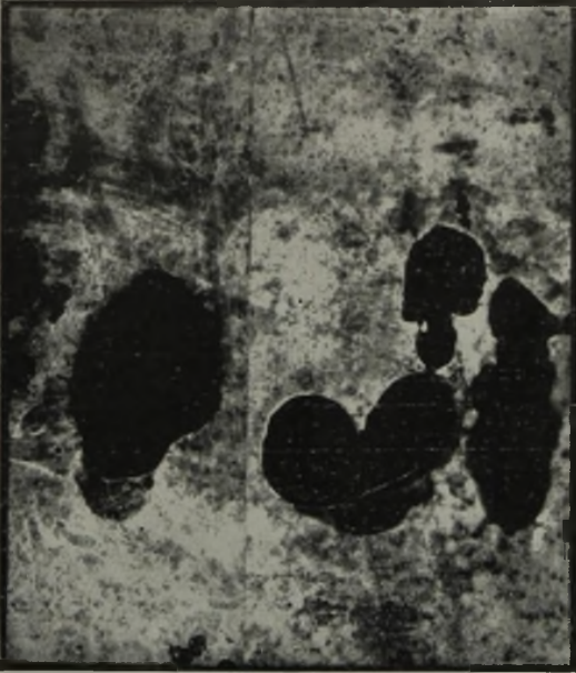
Abbildung 7. Werkstoff A. Gasblasenseigerung. Aetzung I. (Kupferammoniumchlorid.)
