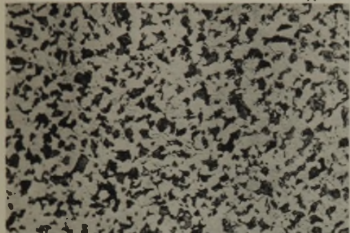
c) Guß aus Eisenschwamm.
