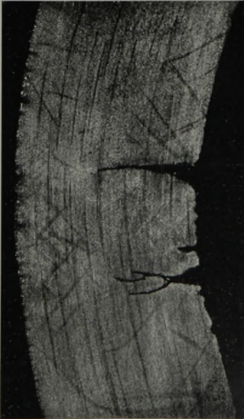
Abbildung 21. Krempenrisse und Fließlinien in einem Kesselboden (Wasserraum).
