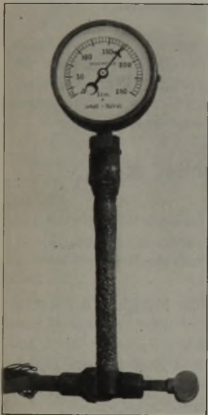
Abbildung 28. Drucksteigerung in einer Eisenhülse durch Beizen.
