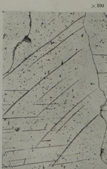
Abbildung 14. Gefüge einer rissigen Schale (vgl. Abb. 13).
