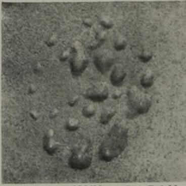
Abbildung 25. Beizblasen in einem gebeizten Blech (Nester).
