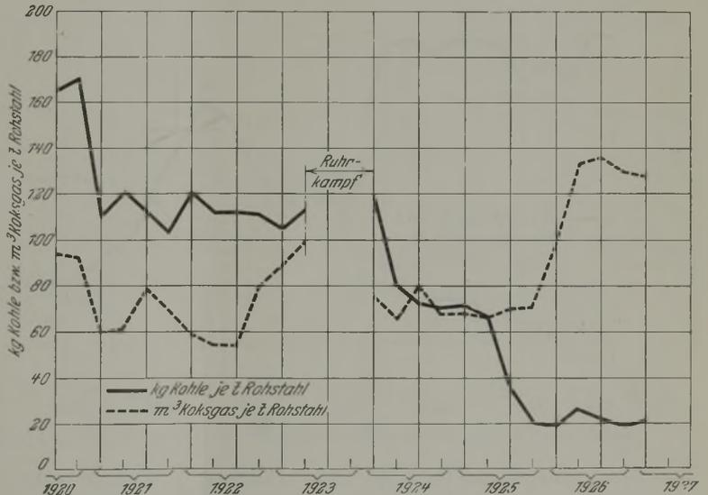
Abbildung 6. Verbrauch an grüner Kohle in kg und Koksgas in  $m^3$  je t Rohstahl auf einem rheinisch-westfälischen Hüttenwerke.
