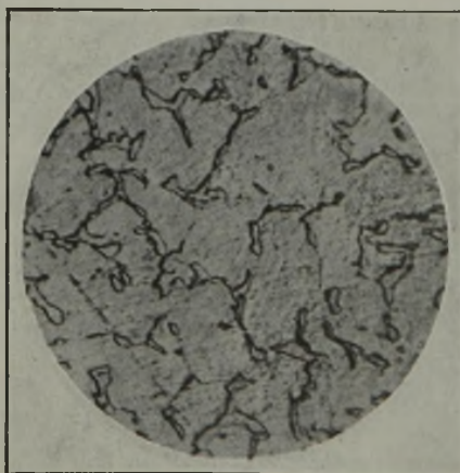
Abbildung 6. Wie Abb. 5; 24 st erhitzt bei 705° und in Wasser abgeschreckt. (Salpetersäure-Aetzung.)
