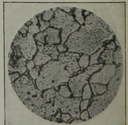
Abbildung 7. Wie Abb. 5; 12 st erhitzt bei 710° und in Wasser abgeschreckt. (Salpetersäure-Aetzung.)
