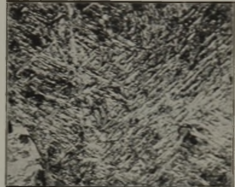
Abbildungen 6 und 7. Gefüge in der Nähe der Schienenoberfläche.
