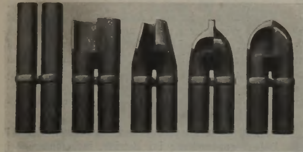
Abbildung 11. Herstellungsgang einer Ueberhitzerkappe.
