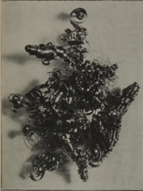
Abbildung 3. Bohrspäne beim Gewindeschneiden mit Flankenschnitt.
