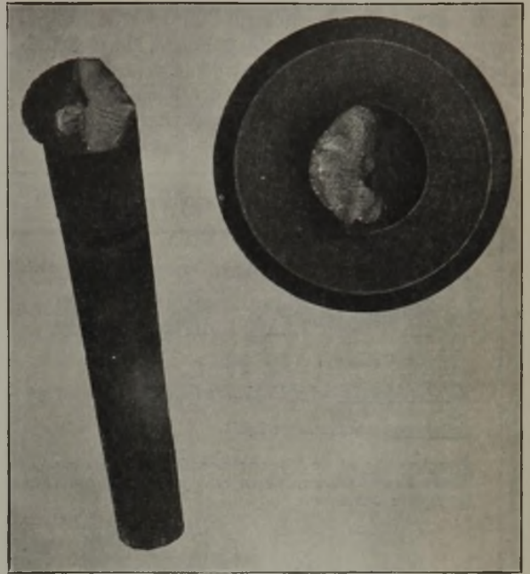
Abbildung 26. Dauerbruch an einem Ventil durch schlechten Uebergang vom Schaft zum Teller.
