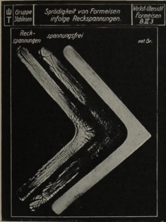
Abbildung 7. Einfluß von Reckspannungen auf ein Formeisen.
