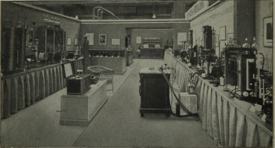
Teilsicht der Chemischen Abteilung: Links Apparaturen für die Gasanalyse, im Hintergrunde Einrichtungen für analytische Chemie, rechts Apparaturen für die Sauerstoffbestimmung im Stahl, davor Hochfrequenzöfen mit Transformator.
