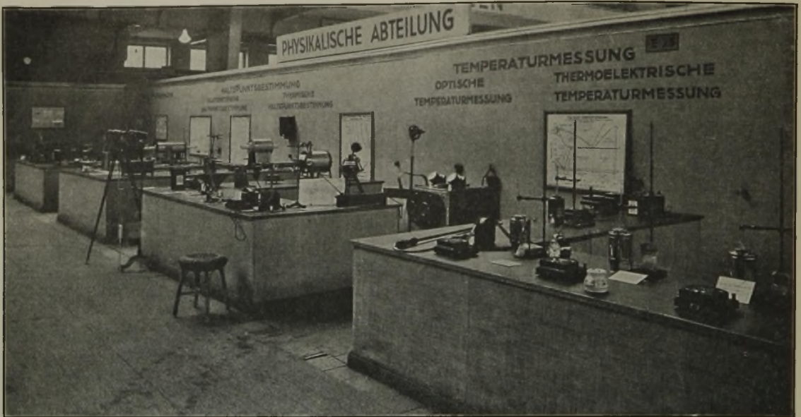
Blick in die Physikalische Abteilung: Einrichtungen für thermoelektrische und optische Temperaturmessung sowie Apparaturen für die Haltepunktsbestimmungen und Wärmeausdehnungsmessungen.
