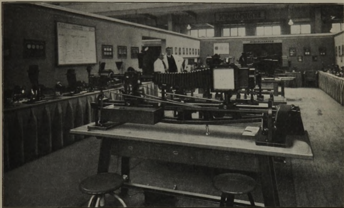
Blick in die Abteilung Metallographie: Auf den Seitentischen Mikroskope aller Art, im Hintergrunde die Dunkelkammer, im Mittelfelde die großen Metallmikroskope für die Gefügeuntersuchung, an den Wänden Gefügebilder aller Stahl- und Eisensorten in den verschiedensten Behandlungszuständen.
