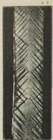
Abbildung 5. Querschliff. Aetzung nach Fry.
