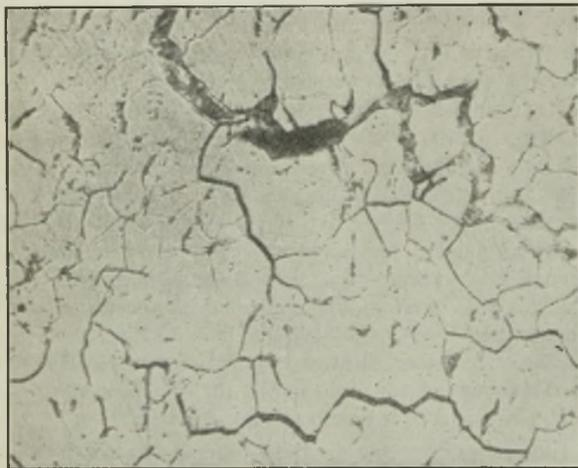
Abbildung 1. Gefüge eines beim Hartlöten gerissenen Stahlrohres nach der Doppelätzung.
