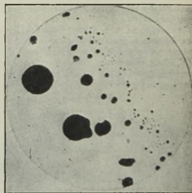
Abbildung 5. Schliffprobe, ungeätzt, mit Schlackeneinschlüssen.
