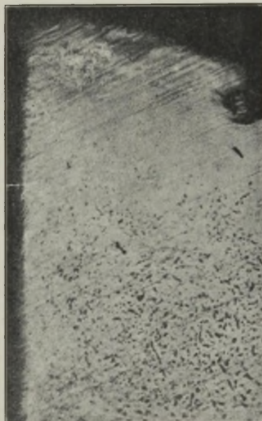
Abbildung 1. Im gewöhnlichen Salzbad entkohlter Feilenzahn.
