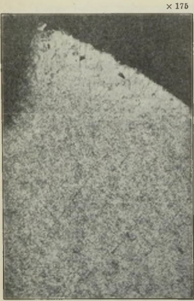
Abbildung 3. Durch starke Entkohlung am Rande ferritischer Feilenzahn.
