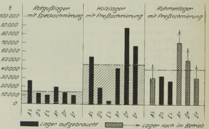
Abbildung 17. Leistungszahlen verschiedener Arten von Walzenlagern.
