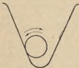
Rys. 17. Momenty kręcące wynikające z bocznego przylegania liny
