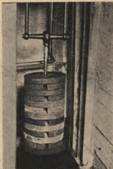
Rys. 9. Ogólny widok sposobu naklejania elektrotensometru na dźwignie hamulca
