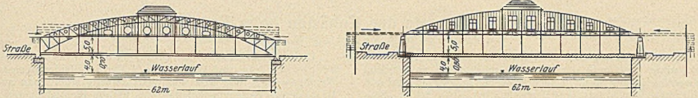
Abb. 2. Grundsätzliche Skizzen von ausnutzbaren Brücken-Überbauten, die bei dreifacher Querträger-Aufhängung geringe Bauhöhe gestatten, sich allgemein aber nicht empfehlen.
