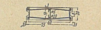
Abb. 9a bis c. Spundbohlen für die 1912-1913 hergestellte Uferbefestigung im Hafen von Ruhrort.
