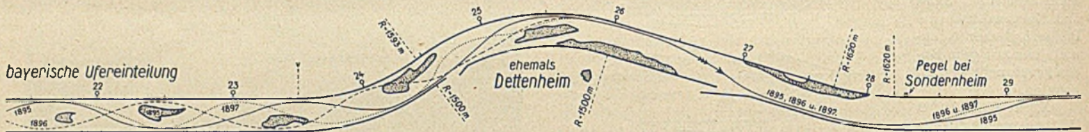
Abb. 1. Talweg des Rheins bei Dettenheim im September 1895, Dezember 1896 und November 1897 samt den Kiesbänken am 25. September 1895 bei 2,65 m a. P. Sondernheim.
