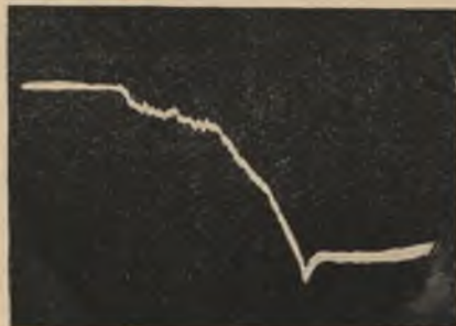
Rys. 4. Oscylogram komutacji opóźnionej. Prądnica bocznikowa 6,3 kW 230 V 1500 ob/min
