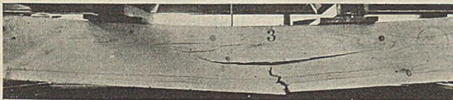
Abb. 10. Biegeversuch I. Vordere Seitenfläche des Balkens unmittelbar nach dem Versuch.
