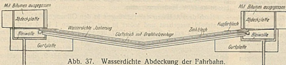
Abb. 37. Wasserdichte Abdeckung der Fahrbahn.
