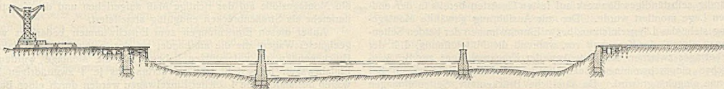
a) Einrichtung der Fahrbahn und Montagebühne auf der Seite Novi-Sad.
