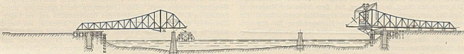
f) Zustand 3 beim Einschwimmen des Kragträgers auf Seite Novi-Sad; Fertigstellung des Kragträgers auf Seite Peterwardein.
