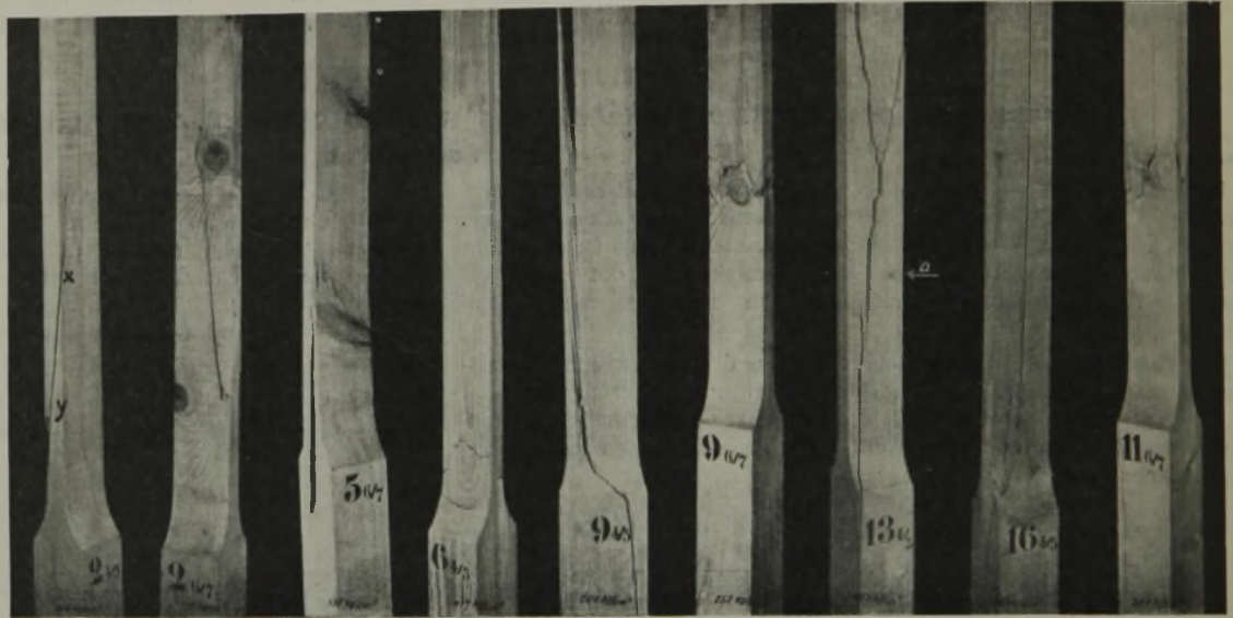
Abb. 4. Bemerkenswerte Bruchbilder nach Zugversuchen mit „nassem“ Holz.
