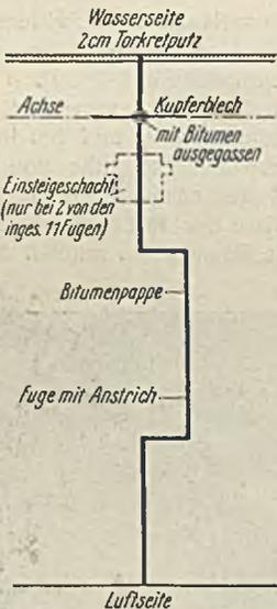
Abb. 12. Fugenausfüllung.
