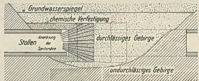
Abb. 18. Chemische Bodenverfestigung mit waagrechttem Vortrieb. Entwurf für die Überwindung eines Schwimmsandabschnittes bei einem Stollen- (Tunnel-) bau.
