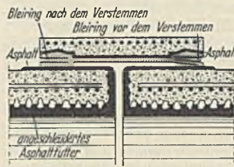
Abb. 35. Dehnungsmuffe mit Dichtungsmanschette aus Blei, deren Enden als ringförmige Treibkeile ausgebildet sind.
