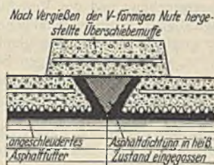
Abb. 34. Stoßverbindung eines Billé-Ligonnet-Rohres.
