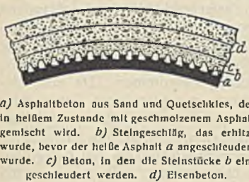
Abb. 33. Querschnitt durch ein Moir-Buchanan-Rohr mit Billé-Asphaltfutter.
