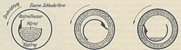
Abb. 30. Wirkungsweise des Kipptroges und Abstreifmessers.
