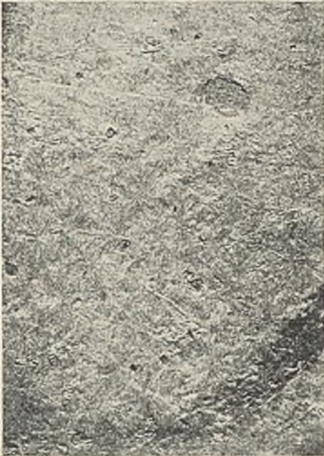
Abb. 5. Feuerverbleiung — höchstens 0,025 mm stark. Gefüge nicht einheitlich. Zahlreiche Poren verschiedener Größe sind auf der ganzen Fläche zerstreut und an ihrer dunklen Färbung deutlich zu erkennen. — Zwanzigfache Vergrößerung.
