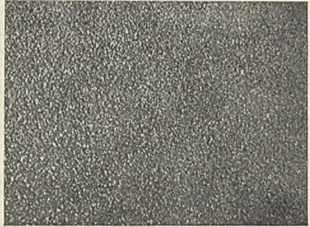
Abb. 6. Galvanische Verbleiung der Firma J. Eberspächer, Eßlingen a. N., etwa 0,2 bis 0,3 mm stark porenfrei verbleit. Das einheitliche Kristallgefüge ist deutlich erkennbar. Die weißen Flecken sind reflektierende Kristallflächen. — Zwanzigfache Vergrößerung.
