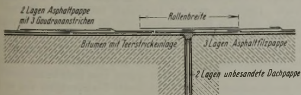
Abb. 10. Dichtung der Fugen im mittleren Teile des Bauwerks.
