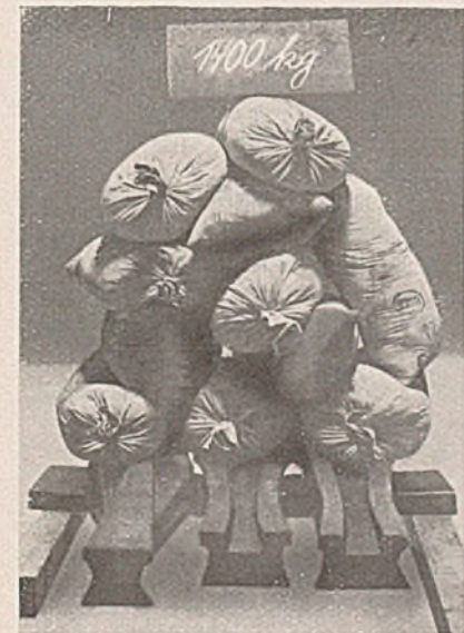
Abb. 6. Belastung einer Platte P.
