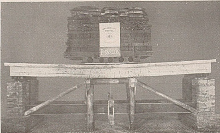
Abb. 13. Bruchbelastung der Versuchsdecke.
