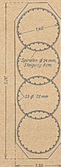
Abb. 14. Querschnitt einer Bogenrippe vom Entwurf der Arstabbrücke.
