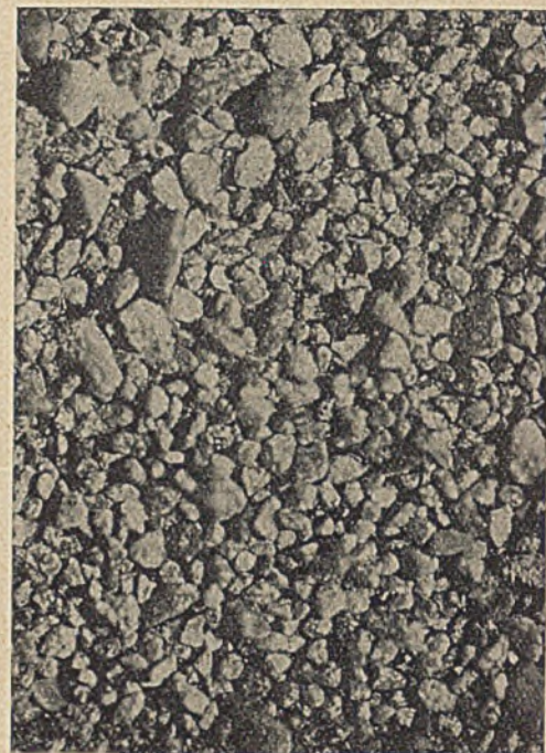
Abb. 2. Sand X (Rückstand vom Sieb mit 900 Maschen auf 1 cm 2 , abgeseibt auf dem Sieb mit 1 mm Lochweite; 0,24 bis 1 mm Korngröße).
