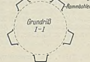
Abb. 13. Aus eisernen Spundbohlen zusammengesetzte Dalben.
