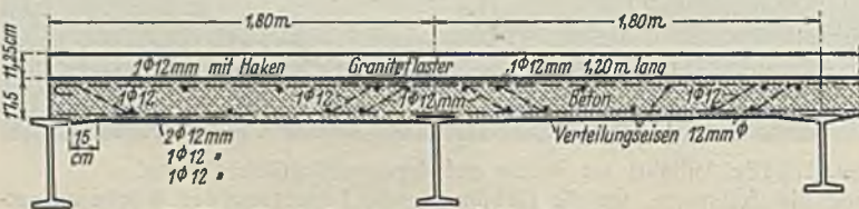
Abb. 5. Längsschnitt durch Fahrbahndecke der Zufahrtrampen.
